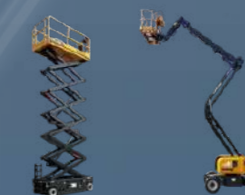
MATÉRIEL D'ACCÈS AÉRIEN
